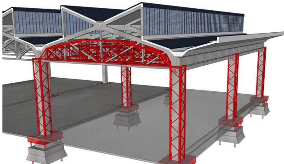
Stato di progetto con evidenziate le nuove strutture ed esecutivo delle nuove capriate principali
